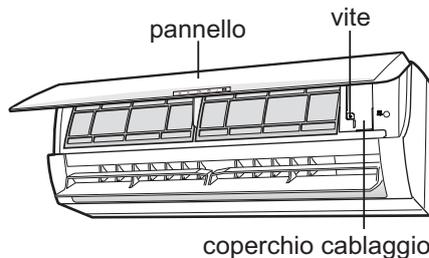
2. Inserire il cavo di collegamento tra l'unità interna ed esterna nel foro posteriore corrispondente alla morsettiera. Poi estrarlo dal lato anteriore.
