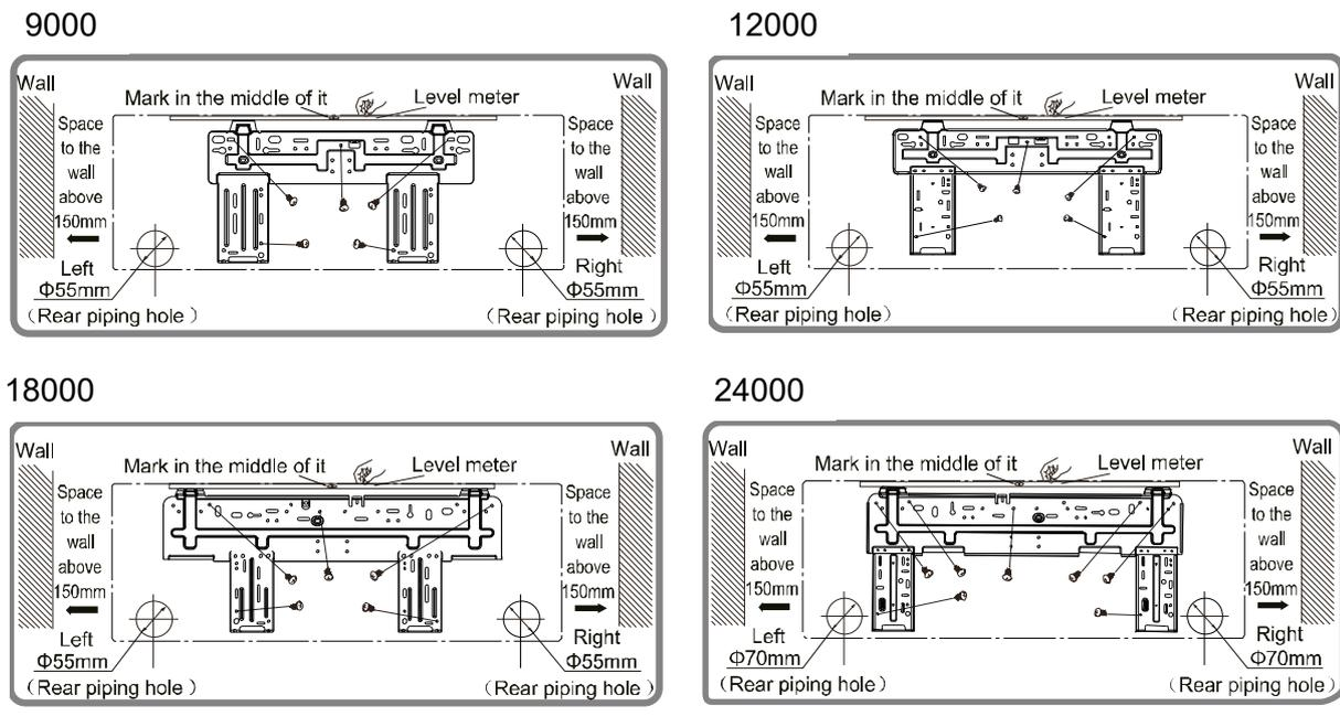
Praticare il foro tubazioni di diametro  $\Phi 55$  o  $\Phi 70$  nella posizione d'uscita appositamente scelta. Per un drenaggio corretto, il foro tubazioni sulla parete deve essere leggermente inclinato verso il basso sul lato esterno, con pendenza di 5-10°.
