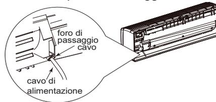
3. Rimuovere la clip del cavo, collegare il cavo di alimentazione alla morsettiera a seconda del colore; serrare la vite e fissare il cavo di alimentazione con la clip.
