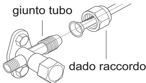
2. Togliere il cappuccio a vite della valvola e posizionare il giunto del tubo nella svasatura del tubo.
