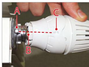
**2)** Agganciare la testa termostatica alla valvola, verificando che piolo della valvola (A), feritoia piccola della testa termostatica (B), simbolo Keymark (C), siano allineati.
