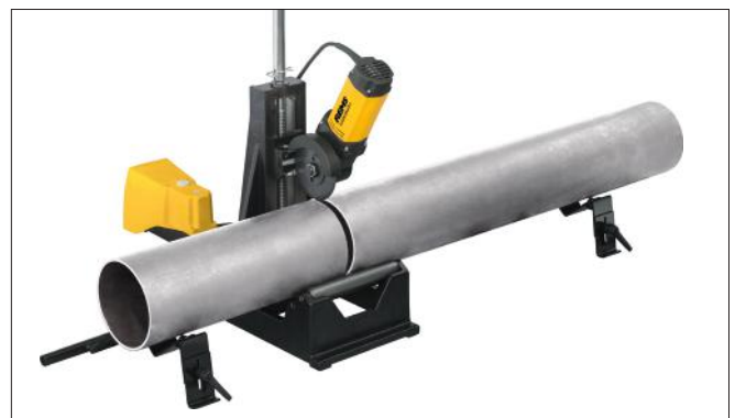
Figura 19 a - Taglio del tubo Oversize
