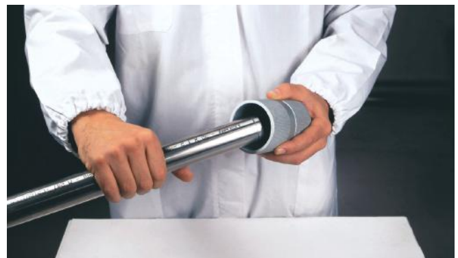
Figura 20 - Sbavatura del tubo
