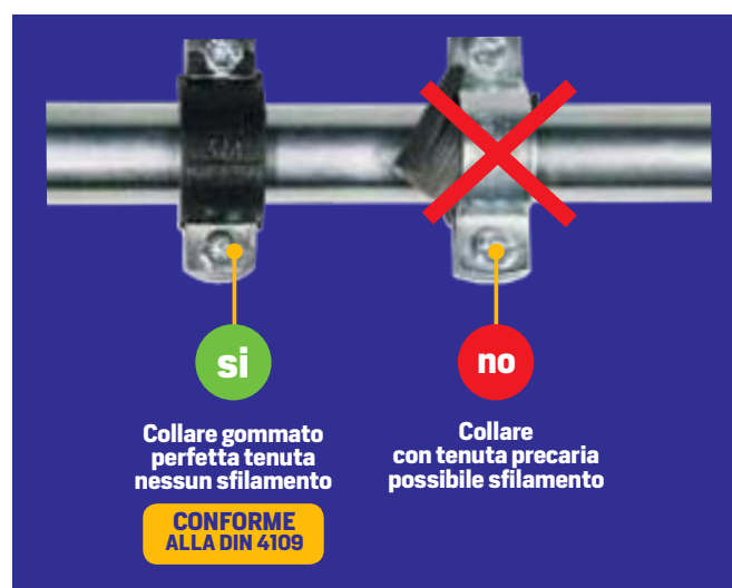
Figura 42 - Collare gommato conforme alla DIN 4109
