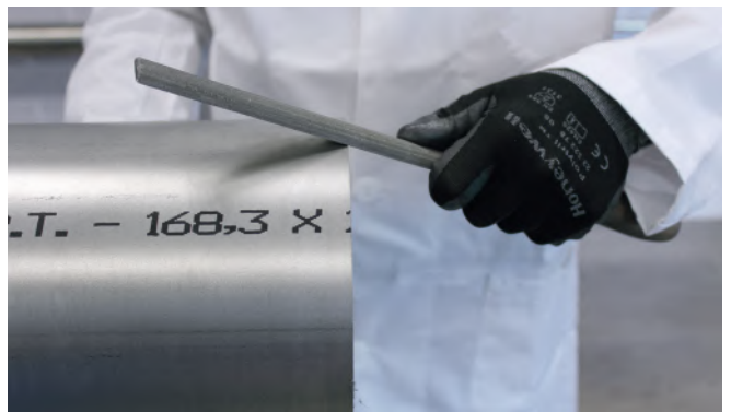
Figura 20 a - Sbavatura del tubo Oversize
