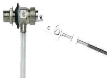
Rubinetto galleggiante silenzioso in ottone stampato, asta regolabile, cappuccio ottone, asta ottone Ø 5 mm filetto 1/4 w
