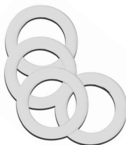
Guarnizione in polietilene espanso ad alta tenuta per pilette da 1"1/4 - ø 62 x 42 sp. 5 mm
