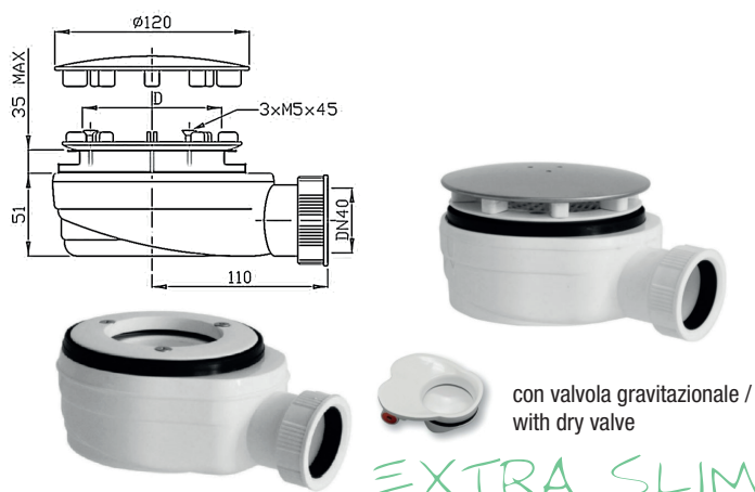
Scarico doccia EXTRA SLIM 90 x 40 altezza 51 mm. uscita acqua 52 l/min.
