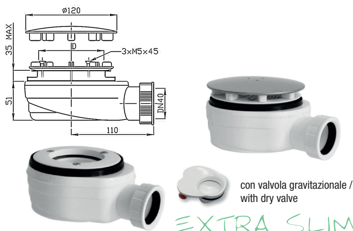
Scarico doccia EXTRA SLIM 90 x 40 altezza 51 mm. uscita acqua 52 l/min.
